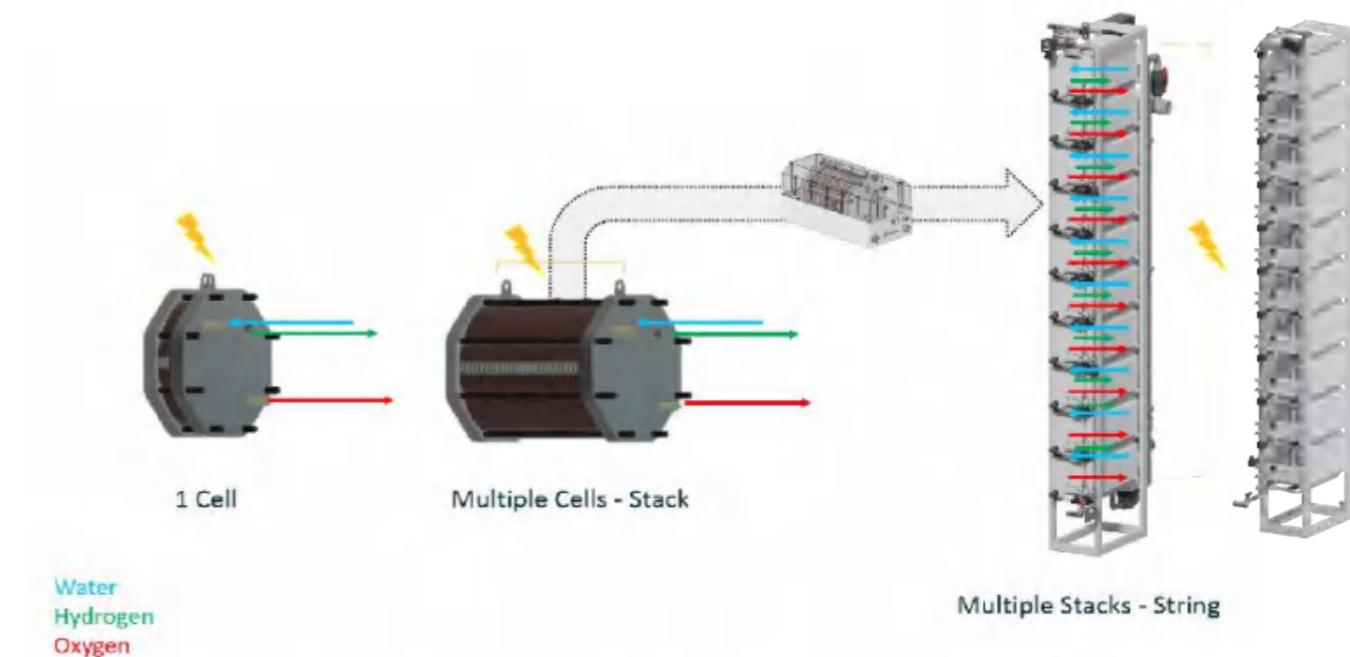
10个Module模块串联成1簇，简化了系统集成，
