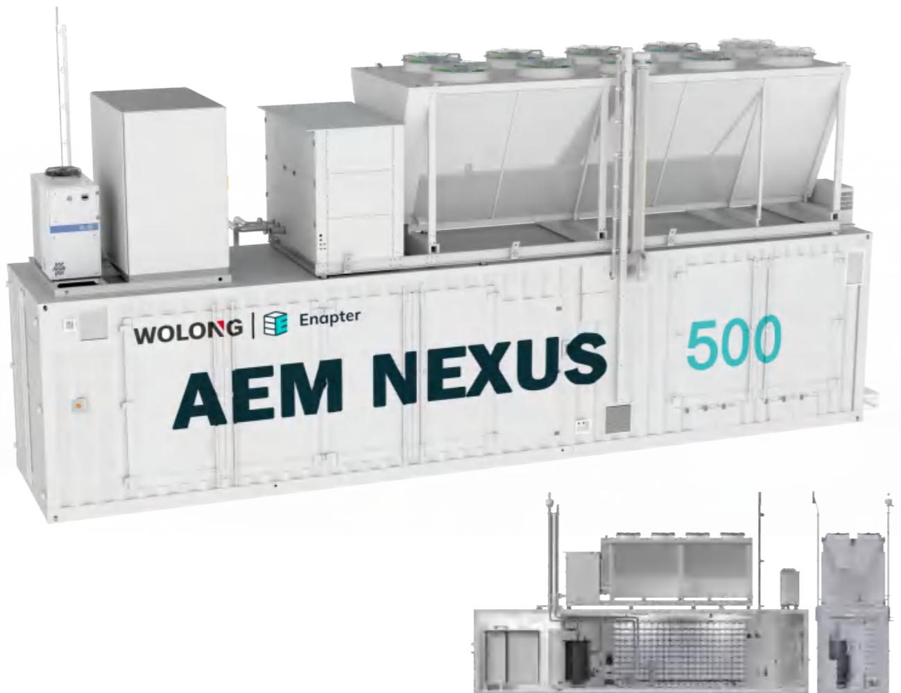
AEM NEXUS500制氢设备是一种高效、环保的水电解制氢设备，主要工作原理是利用阴离子交换膜，在直流电的作用下将水分解为氢气和氧气。设备通常包括电解槽、阴离子交换膜、电极、电源系统等核心组件，能够高效、稳定地实现水电解制氢。
