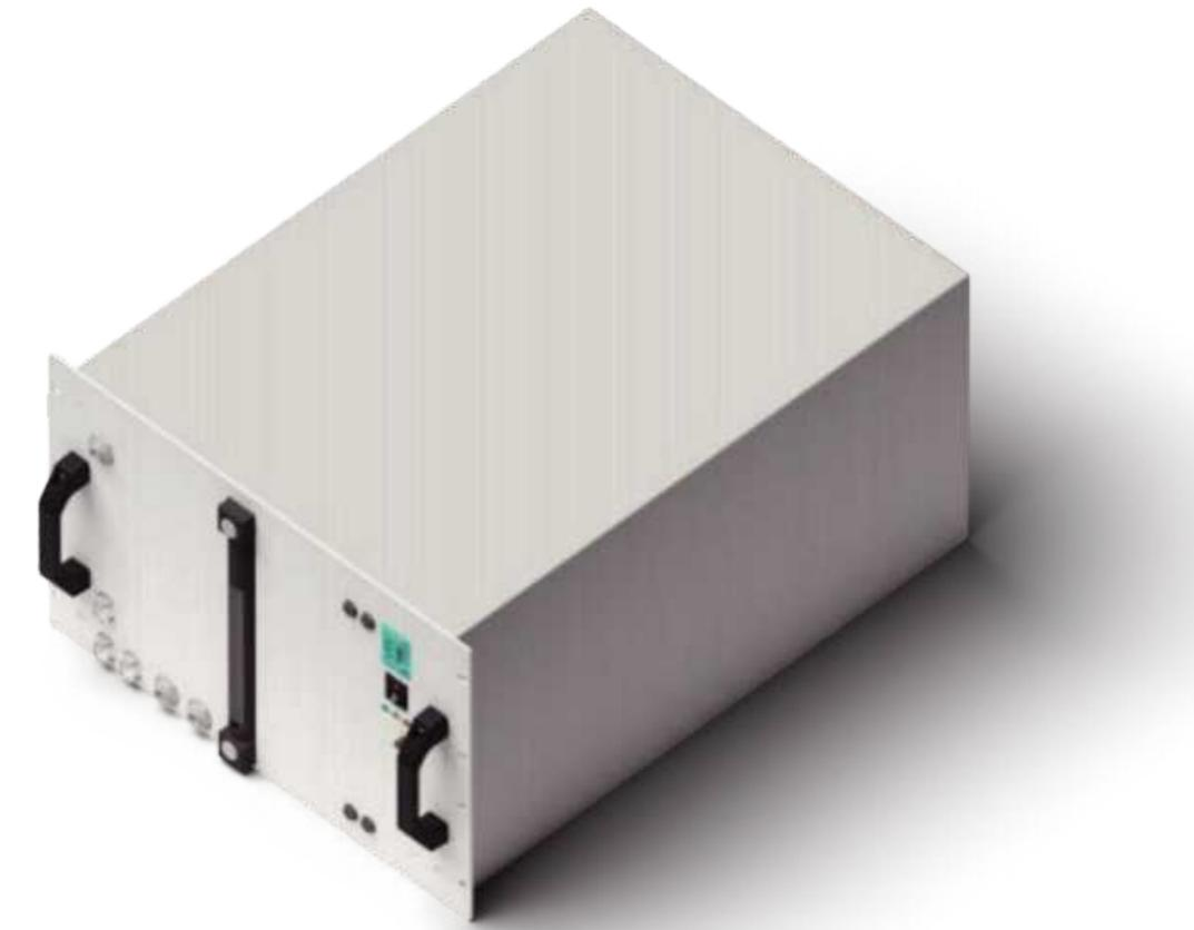
Enapter 水箱可为 AEM 电解槽存储38升纯净水。水箱可安装在标准19英寸机柜中。水箱包含电导率传感器和可为多达11个AEM电解槽提供洁净水的泵系统。
